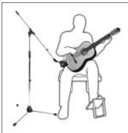
Fig. 7 : Guitare sèche avec un C 214
