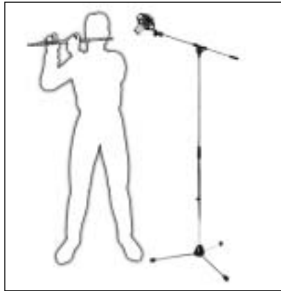
Fig. 8 : Prise de son d'une flûte traversière au moyen d'un microphone unique
